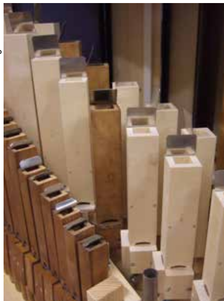
Oude en gereconstrueerde pijpen van de Jubalflöte 8' (met twee labia).
